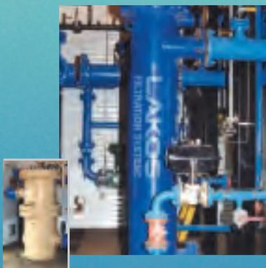
▶ Ahorros anuales superiores a \$100.000 dólares se le han atribuido a esta aplicación LAKOS para agua de producción, que reduce el desgaste de la bomba, el daño a un hidrociclón de separación aceite-agua (ver foto) y los paros por fallas y mantenimiento en general.
