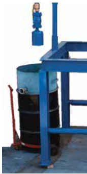
Sistema de decantación con cubierta del tambor (SDS)
