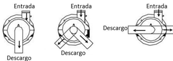
**Fig. 9** Orientación recomendada para la tubería.
